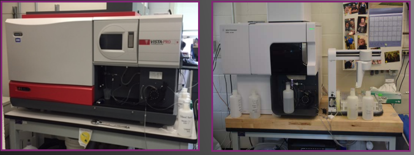
2003-2016 ICP-OES Varian Vista PRO Ca, Mg, Na, & K 2015-2016 ICP-OES Agilent 5100 Ca, Mg, Na, & K
